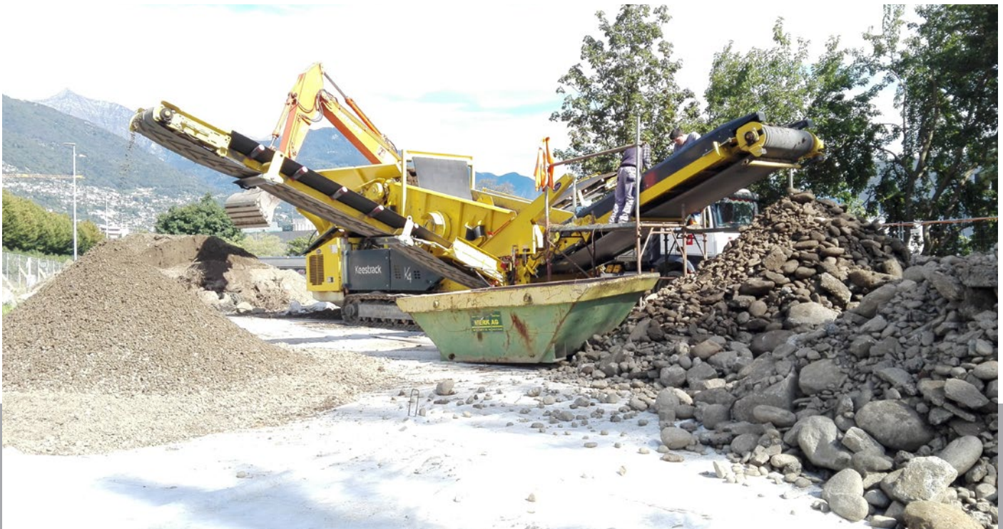
Mobile Siebanlage zur Entfernung von Knöterichrhizomen
