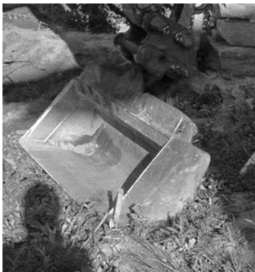
Figura 5: benna senza denti. (Foto: S. Gregori, 2018)
