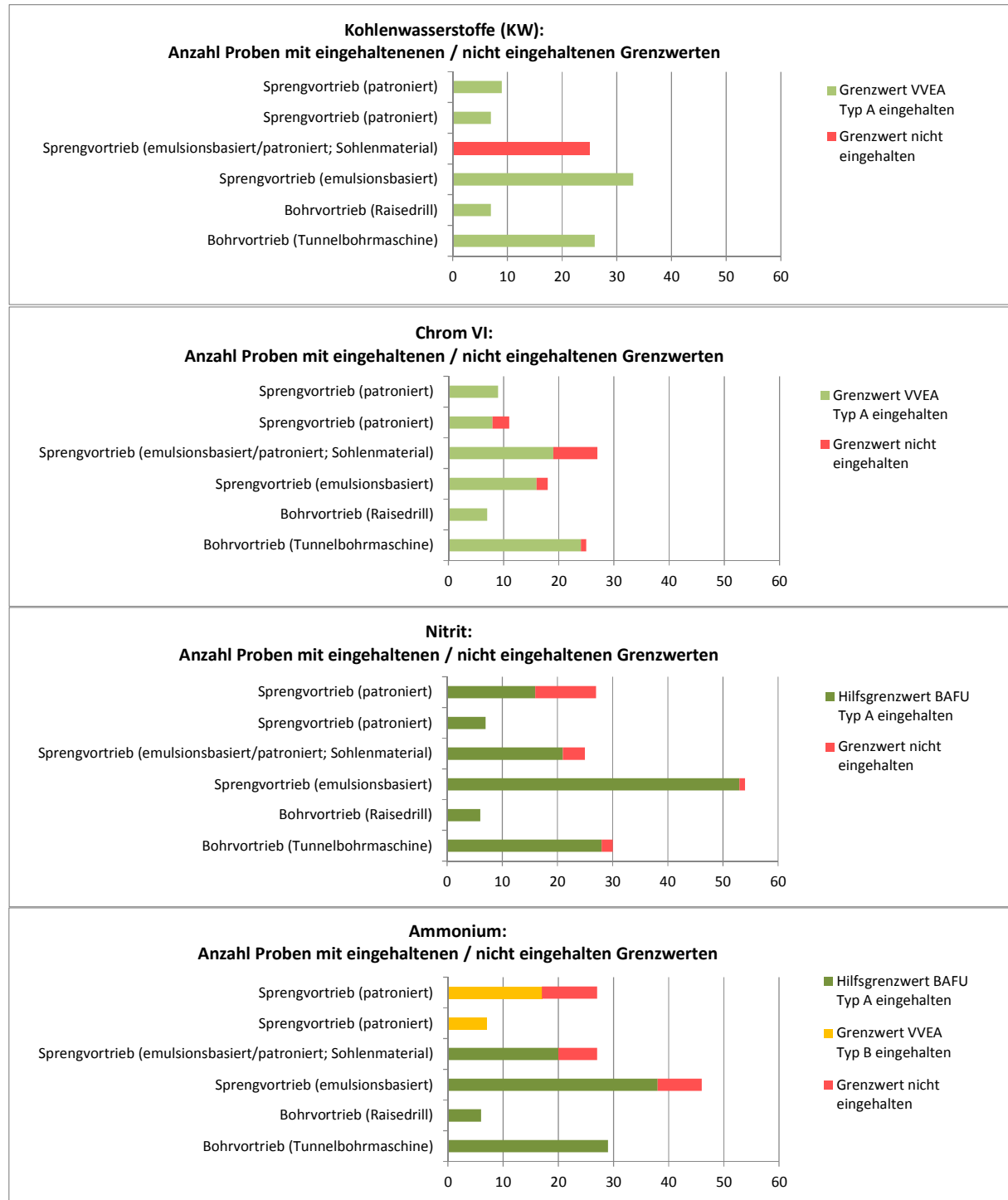
Abbildung 5: Schadstoff-Messungen im Tunnelausbruchmaterial von Tunnel-/Stollenbauprojekten
