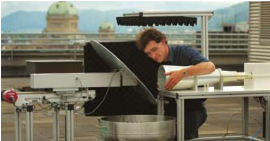
**Mit diesem Gerät erfassen Forschende der Universität Bern das Wasserdampfprofil der Atmosphäre.**
