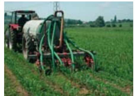
L'épandage d'engrais à même le sol produit moins de gaz à effet de serre.
