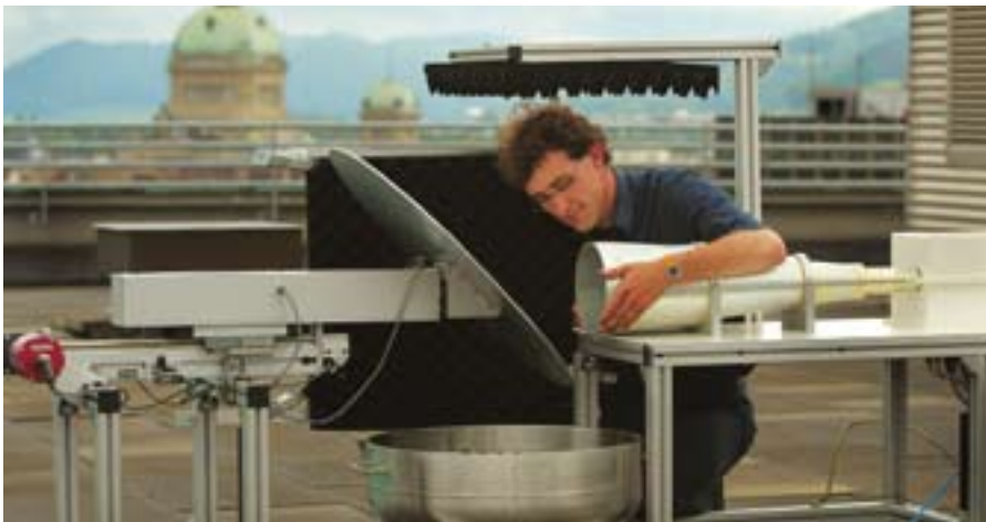
Avec cet appareil, les chercheurs de l'Université de Berne mesurent la teneur en vapeur d'eau de l'atmosphère.
